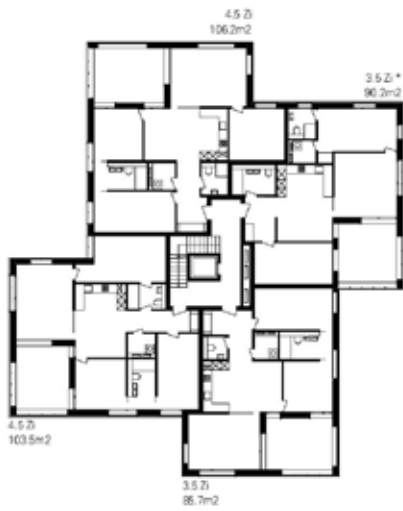
Grundriss Neubau 1. - 5. Obergeschoss
